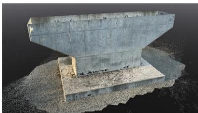
PIX4Dcatchで撮影したデータをパソコンにエクスポートしてデスクトップ処理(PIX4Dmatic活用)または、クラウド上にアップロードして処理(PIX4Dcloud活用)します。
